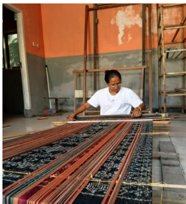
Gambar 3. Proses Penenunan Tenun Ikat Menjadi Sarung
