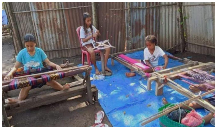
Alat-alat yang digunakan dalam tane ekang (menenun) yakni wulo (bambu ukuran kecil yang panjangnya 1 m digunakan untuk membatasi benang bagian tengah dan atas agar memudahkan proses menenun), meniti (kayu yang panjangnya 1 m digunakan untuk mengencangkan benang agar tetap rapi saat menenun), gurung bleing (penggulung benang), kedaya (penahan kaki), dan ligu (sandaran), nugi (duri babi landak yang digunakan para penenun untuk merapikan benang)
