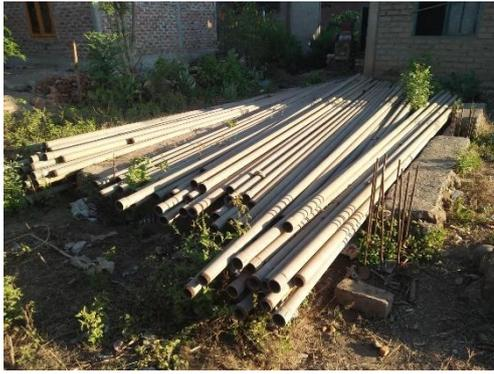
Pipa-pipa yang digunakan untuk mengalirkan air dari mata air di Kalikasa, Kecamatan Atadei. Pipa-pipa ini telah dibongkar dan dikumpulkan di sekitar rumah warga. Foto diambil pada Juni 2021.
