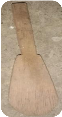
Tutu Liman (berfungsi membentuk sisi dalam unu tana).
